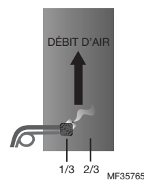
Fig. 9. Distributeur installé horizontalement dans un conduit vertical. Faites tourner le distributeur de 45° pour que la vapeur soit déchargée vers le centre de la gaine, en direction du débit d'air.
