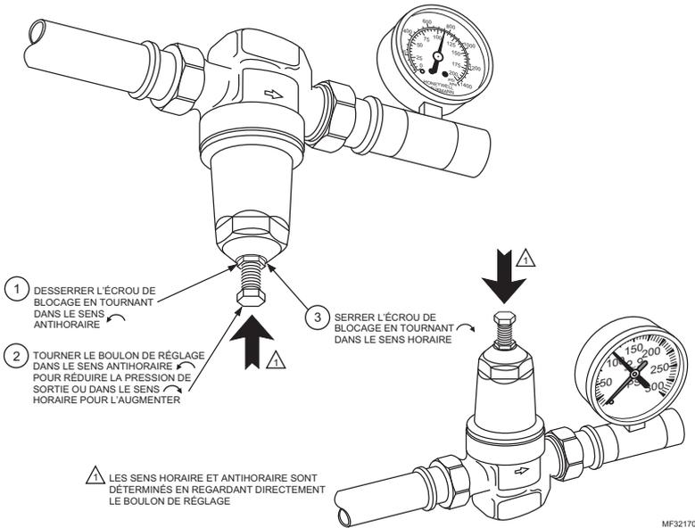
Fig. 5. Modification de la pression de sortie.
